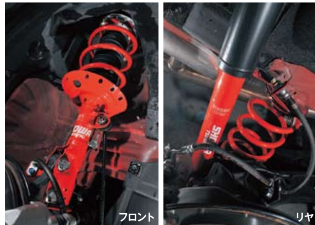
●乗り心地とのバランスがとて難しい、入力に対しリニアに反応するピストンをあえて採用したおかげで、フリクションの少ない、ダイレクト感のあるステアフィールを実現している
