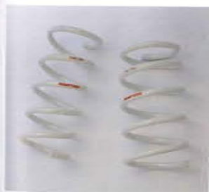
スプリングはダンパーと同調しながら伸縮するが、路面に対して直角に取り付けられているわけではないので、バネの反力線を最適化する必要がある。それを行ったのが中央発條製の新スプリング。微妙なRがついているのがわかる
