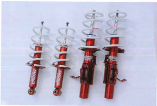
右側がフロント用で、左側がリア用。ダンパーはショーワレッド、スプリングはホワイトパールにペイントされ、美しい仕上がりを見せる。スプリングレートは前期用と同じくフロントが35.0N/mmでリアが44.0N/mm。ローダウン幅は前後ともに約15mmとなっている
