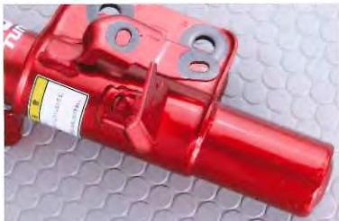
フロントは、ストラット式フロントショックの剛性向上とSFRD機構用スペースとして、ボトム部のケースを60mm延長している。必要にして十分なストローク容量を確保した。
