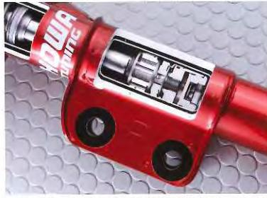
路面や車速、ステアリング操作で変化するダンバーの作動周波数に応じ、オイル経路を使い分けるSFRD機構をシリーズ初採用する。微低速域からしっかりとした手応えが出る。
