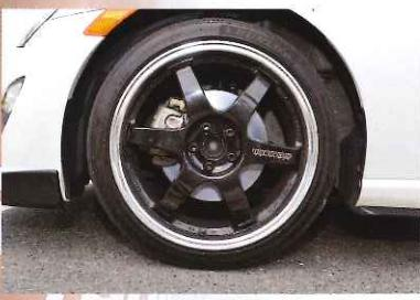
テスト時に装着されていたタイヤは、フロント215/45R18の純正オーファンションサイズのディレッツァZ II。ブレーキはプロジェクトMのバッドで強化している。
